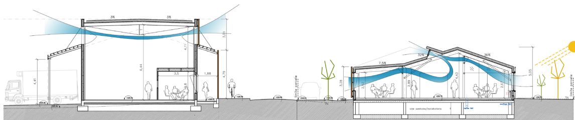
Coupe des ateliers et des bureaux avec concept bioclimatique
