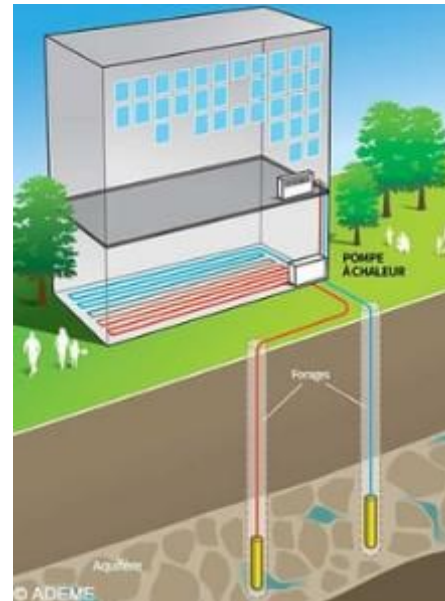
Captage sur nappe Echange d'énergie : boucle ouverte
